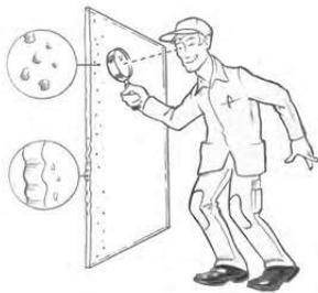
1. In der Falzzone (Zone R) sind alle Beschädigungen zulässig, die durch den Produktionsprozess entstanden sind. Ausnahmen bilden mechanische Kantenbeschädigungen durch Einwirkungen von Außen.
